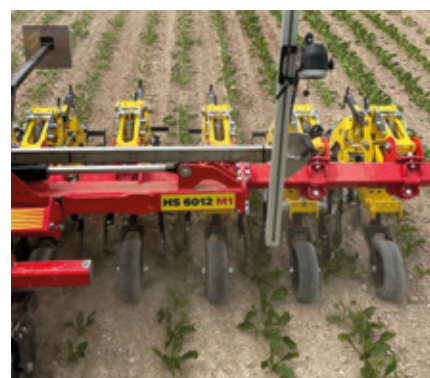
Camera poziționată exact deasupra rândului detectarea a 3 rânduri
