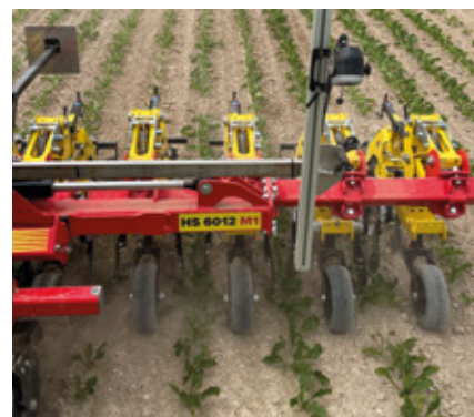
Kamera genau über der Reihe 3-Reihen-Erkennung
