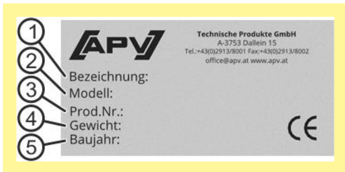
Afbeelding 2: opbouw van het typeplaatje
