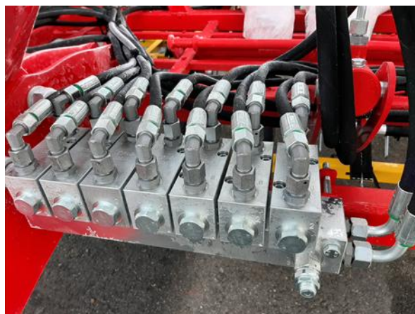
Abbildung 14: Mengenteiler am Mittelrahmen
