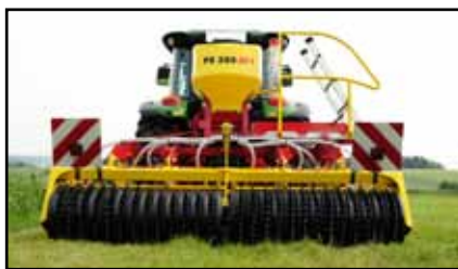
Figura 9: Nivelarea - grăparea - însămânțarea - tragerea cu tăvălugul: GP 300 M1 + PS 300 M1
