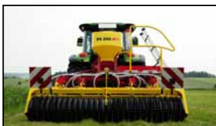
Рис. 9: Разравнивание + боронование + посев + прикатывание: GP 300 M1 + PS 300 M1
