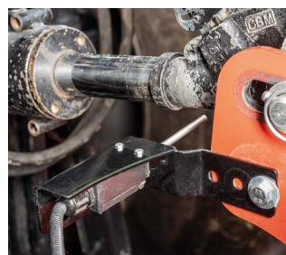
czujnik pozycji TUZ montowany na ciągnie górnym
