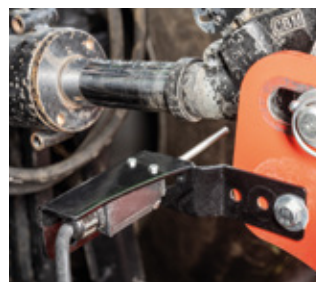
Sensore dispositivo di sollevamento barra superiore
