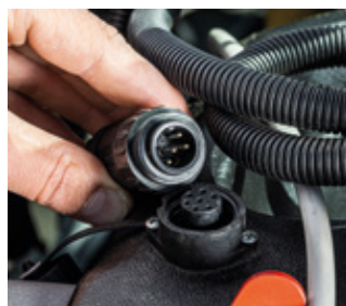
Cablu de semnal cu 7 poli
